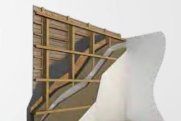
Doublage intérieur de murs maçonnés: isolation rapportée avec parement sur ossature métallique.
