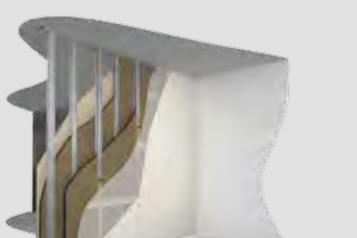
Doublage intérieur des murs briques : Isolation rapportée avec parement sur ossature métallique.
