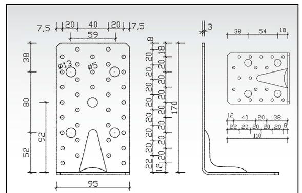
Zu befestigen mit GH Rillennägeln (Seite 85), GH Schrauben (Seite 86).
