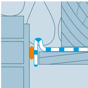
TESCON PROFIL a largement fait ses preuves pour le raccord des membranes INTELLO aux fenêtres, portes et angles. Grâce à ses trois bandes de film transfert détachables séparément, ce ruban adhésif d'angle permet des collages propres et précis.
