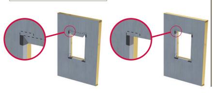
Etape n° 4 Mise en place des bandes adhésives pour finaliser l'étanchéité du cadre d'ouverture.
