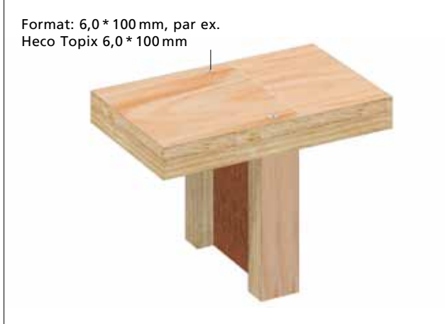
W6 Assemblage de lisse et montant avec vis à bois
